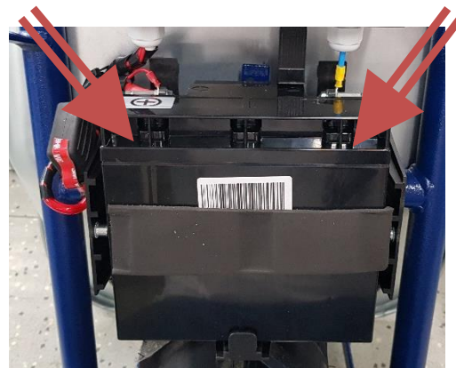
Abb. 8. - markierte Stelle, wo der Akku von den Kabeln abgeschraubt wird.
